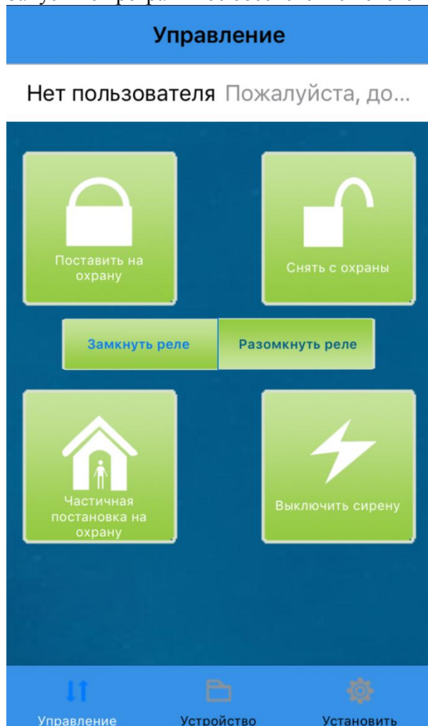
Рис. 1.2. Функции GSMпанели в программном обеспечении мобильного телефона
