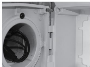
Вставьте винт дверной петли
